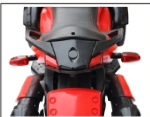
17. Apăsăți lămpile spate, de pe stânga și dreapta, ferm în caroseria trike-ului
