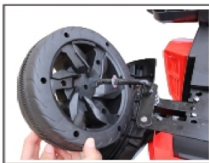
11. Înlăturați piulița și șaiba de pe ax după care introduceți roata față.
